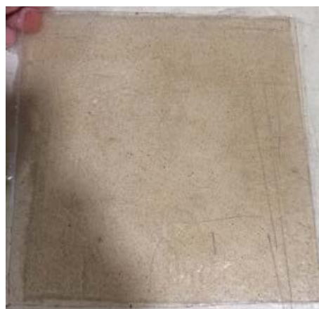
Figura 6. Biocompuesto elaborado de PLA con 2% de MFC.
