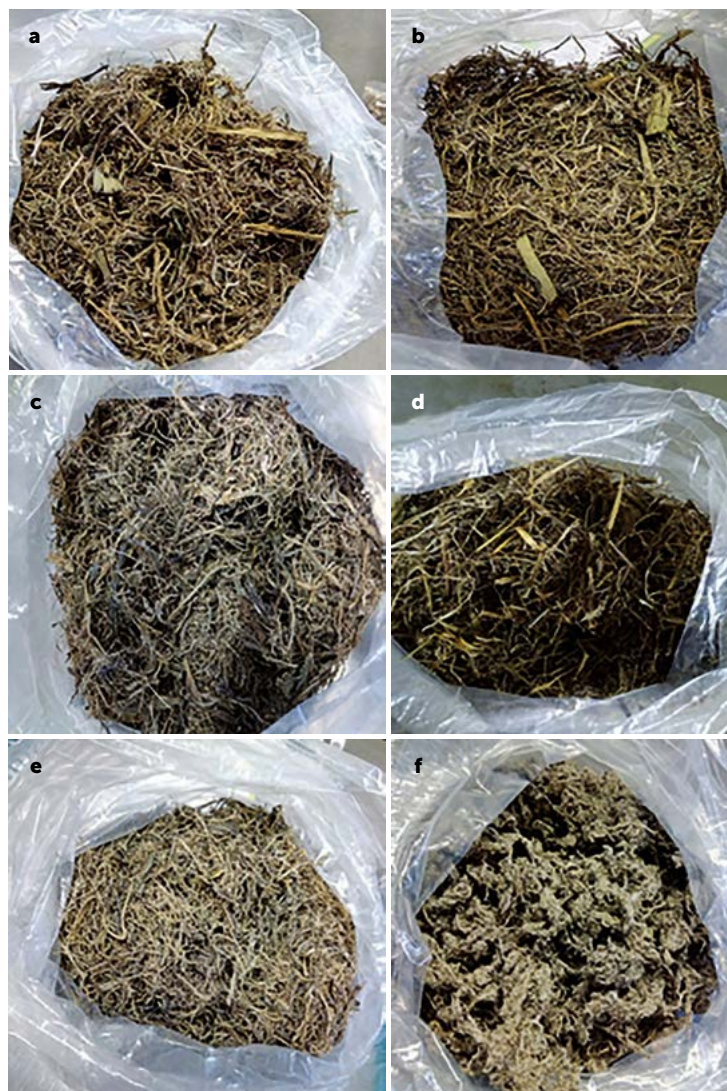
Figura 1. Fibra de celulosa y rechazo obtenido por cada tratamiento. a). hidróxido de calcio 10%, b). hidróxido de calcio 15%, c). hidróxido de calcio 20%, d). hidróxido de calcio 25%, e). hidróxido de calcio 30% y f). hidróxido de sodio 10%.
