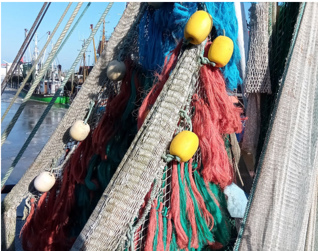
Abbildung 3: Bunte Scheuerschutzfäden (»Dolly Ropes«) an der Unterseite eines Nordsee-Baumkurrennetzes
