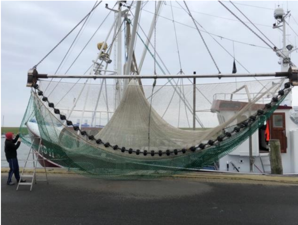
Abbildung 53. Gesamtansicht der Rollerkette mit achsversetzten Rollen auf dem Krabbenkutter 'Hindenburg' (Stefan Schneiderei). Das Rollengeschirr ist verdreht und die Rollen stehen in den Flügelbereichen entgegengesetzt ihrer Bestimmungsrichtung.
