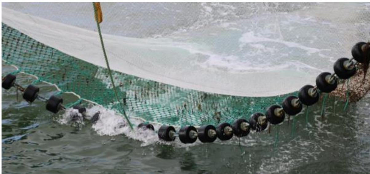
Abbildung 64. Großmaschiges Netztuch im vorderen Unterblatt.
