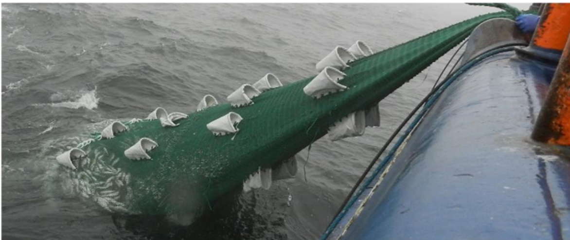
Abbildung 29. Beispiel für Schersegel: Am Steert angebrachte Schersegel, die den Decksteert bei Schleppnetz-Selektionsversuchen auf FFS „Solea“ durch Anströmung aufspreizen.
