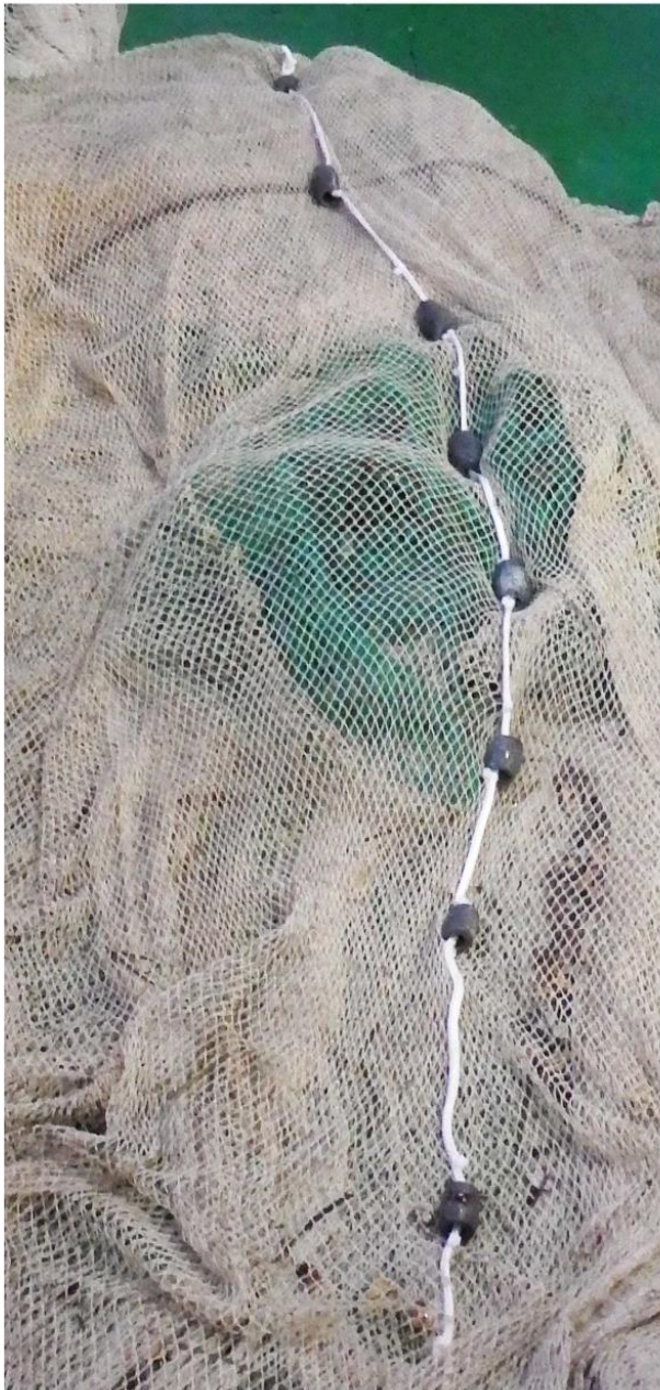
Abbildung 24: Bleistücke, die nachträglich auf der mittleren Maschenreihe des Auffangsteertes angebracht wurden Figure 24: Lead pieces which were subsequently attached to the middle row of meshes of the cover cod end
