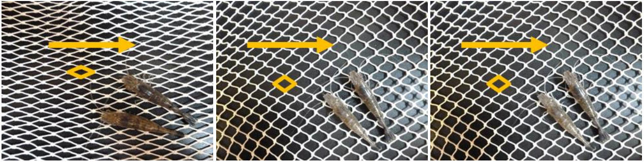
Abbildung 43: Ausrichtungen von Netzmaterial. Links: standardmäßig in der Krabbenfischerei verwendete T0-Netzausrichtung (T0=turned 0° = gedreht 0°); Mitte: T90-Netzausrichtung (T90=turned 90° = gedreht 90°); Rechts: T45-Netzausrichtung (T45=turned 45° = gedreht 45°)
