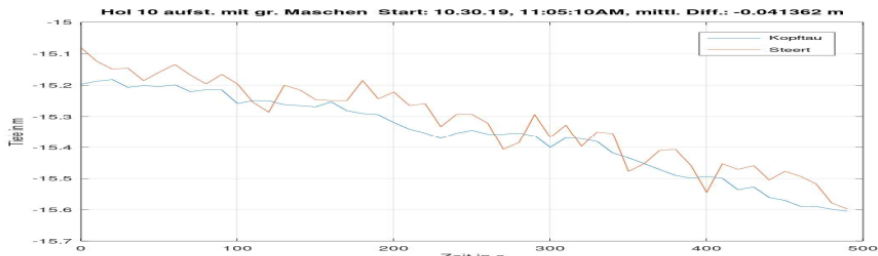
Abbildung 56: Tiefenmessung 1 an der traditionell zugeschnittenen Kurre mit großen Maschen im Unterblatt
