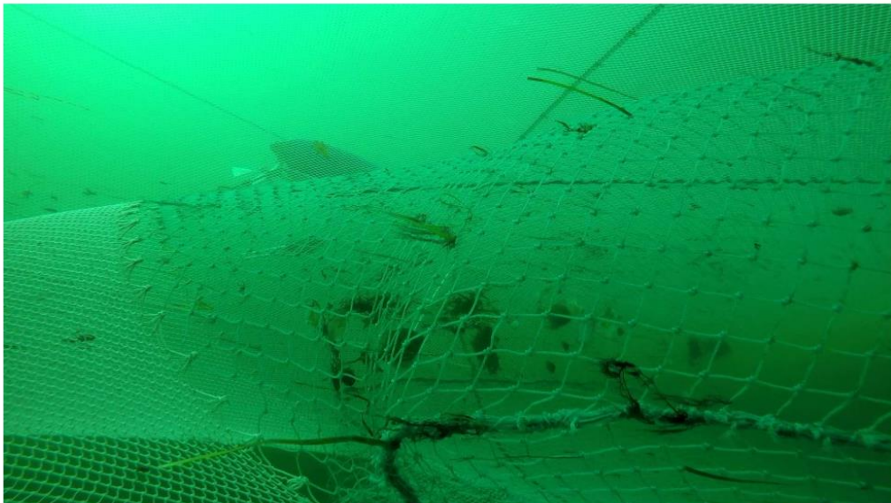
Abbildung 29: Blick von der Seite auf den Ansatz des Siebnetzes an die Auslassöffnung im Unterblatt Figure 29: View from the side of the sieve net attachment to the outlet opening in the lower panel.
