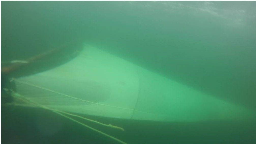
Abbildung 43: aufsteigend zugeschnittene Baumkurre im Hievprozess Figure 43: Ascending beam trawl in the lifting process
