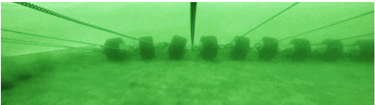
Abbildung 57. UW-Aufnahme der Baumkurre mit geradem Grundgeschirr (Ostsee). Zu sehen hier das „Taumeln“ der Rollen.
