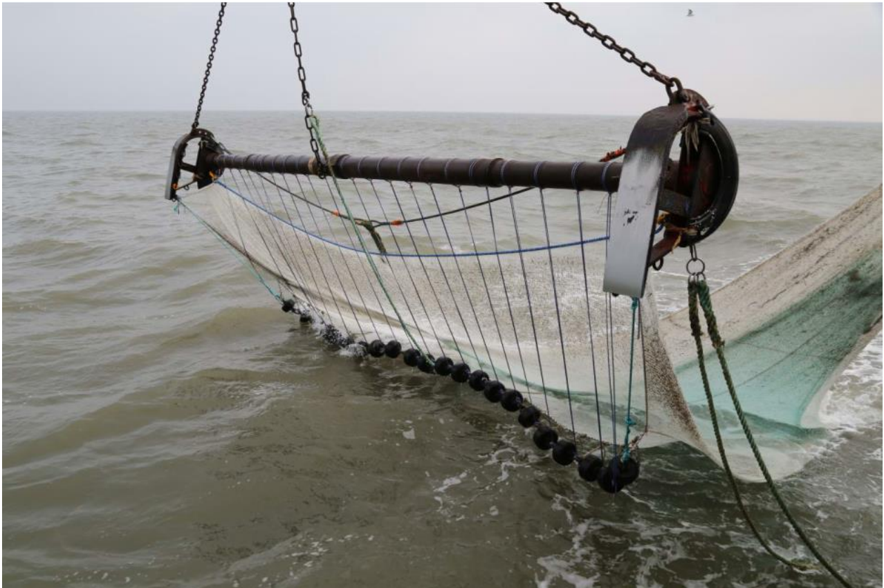
Abbildung 56. Baumkurre mit geradem Grundgeschirr auf FFS „Solea“ im Einsatz.
