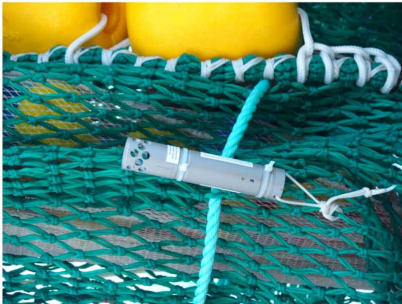
Abbildung 7: STARMON- Neigungswinkel-Tiefen- Logger Figure 7: STARMON Tilt- Depth- Logger
