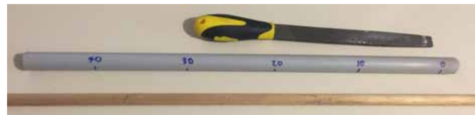
Figure 10.4. Tuyau de 20 mm affûté et goujon de 13 mm (source : Richard Stirzaker)
