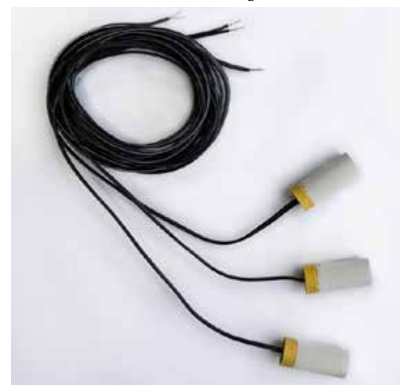
Illustration 10.1b. Ensemble de trois capteurs de la carte Chameleon
