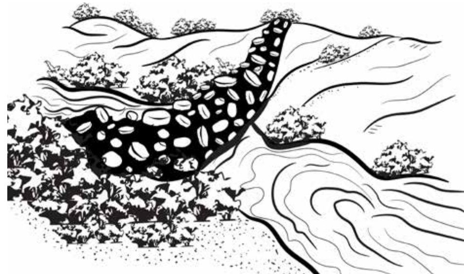
Construction d'un barrage en remblai de blocs de pierre en travers d'un cours d'eau
