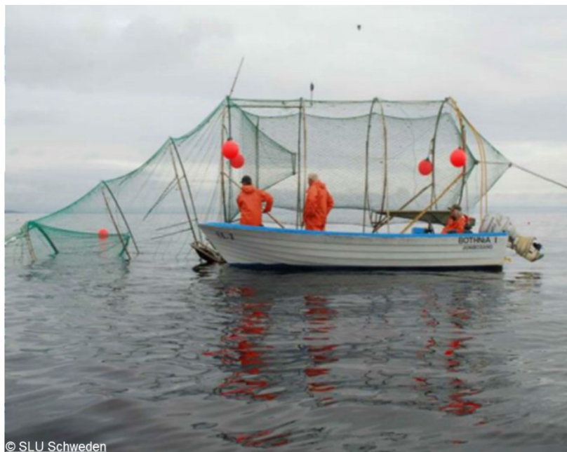
Abbildung 20: ‚Besehen‘/Heben einer originalen skandinavischen Ponton-Hebereuse. Bild aus der skandinavischen Lachsfischerei: Bild: SLU Schweden
