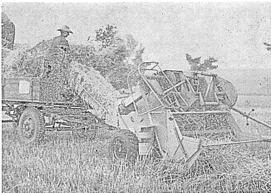
6. ábra. K—441 jelű bálázógép munka közben
