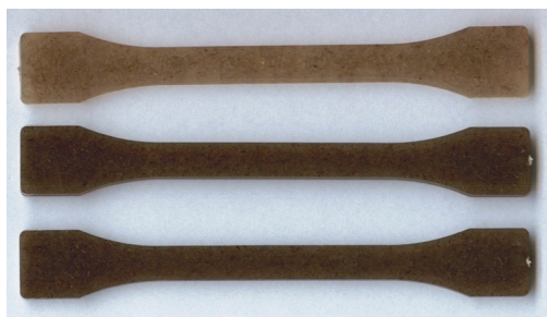
Figure 7. The samples of composite materials strengthened by natural fibres Zdjęcie 7. Próbki materiałów kompozytowych wzmocnionych włóknami naturalnymi
