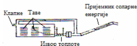
Слика.7. Соларна сушара са допунским извором енергије и сушењем материјала у тавама
