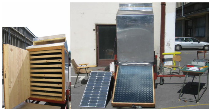
Слика.8. Прототип модула покретне универзалне соларне сушаре
