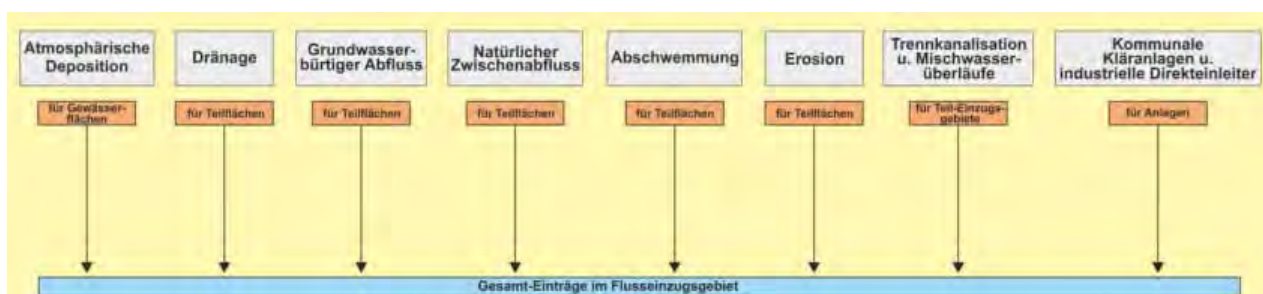
Abbildung 11: Schematische Darstellung der Modellierung des mehrjährigen mittleren Phosphoreintrags mit MEPhos
