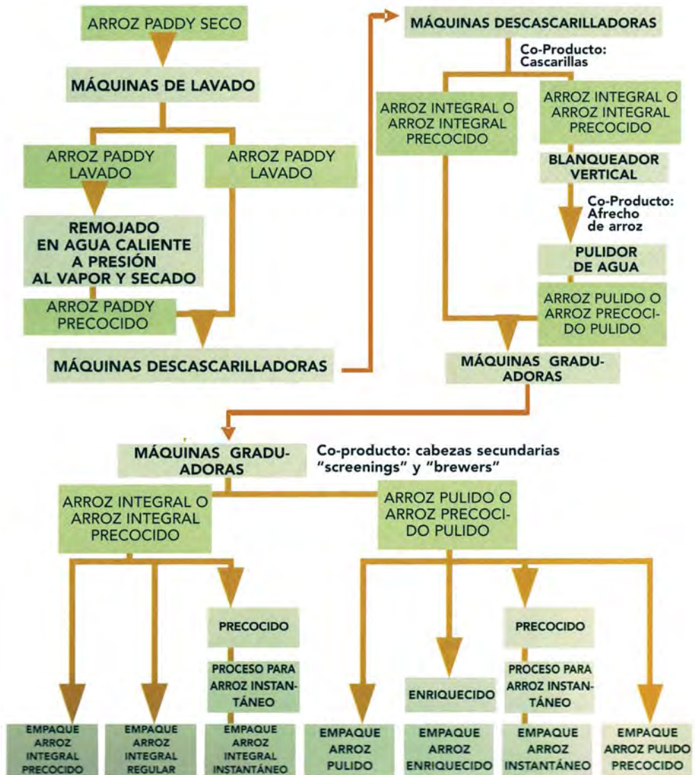
Figura 22. Proceso de molienda del arroz; lavado, descascarillado, precocido
