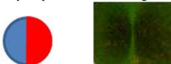
2.ábra A bal oldalon a szokásos színek jelölik az É és D pólust, a jobb oldalon a mágnesfilmmel láthatóvá tett mező. Az É és a D pólus nem különböztethető meg egymástól.
