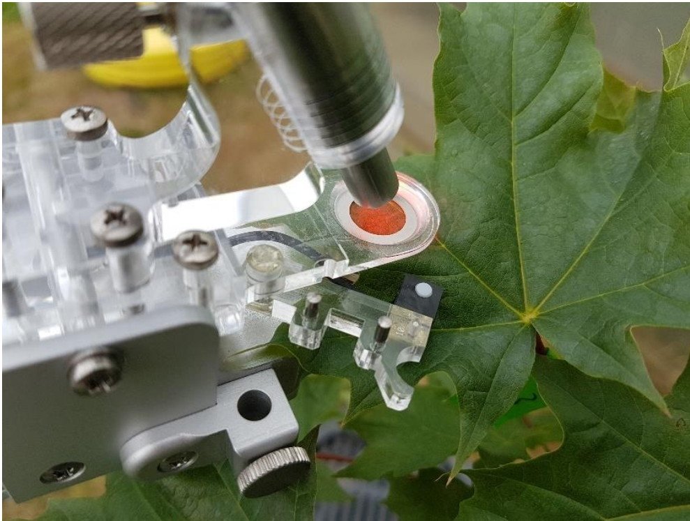
Abb. 2: Leaf Clip Holder mit Sensor in der richtigen Position.
