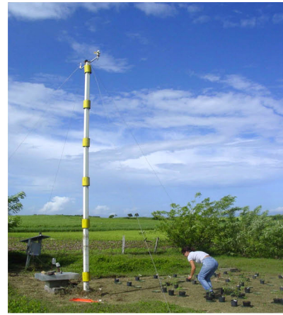
Photo 2. Dispositif de suivi des populations de Bemisia tabaci (pièges jaunes cylindriques englués, coulissant le long d'un mât).
